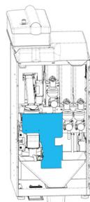
**3** Installer le rouleau de papier-filtre. Passer le papier sous le support de gauche du système d'infusion, sous la chambre d'infusion et sous les roues de guidage en les soulevant légèrement avec l'étrier. Réinstaller le panneau de protection et refermer la porte.
