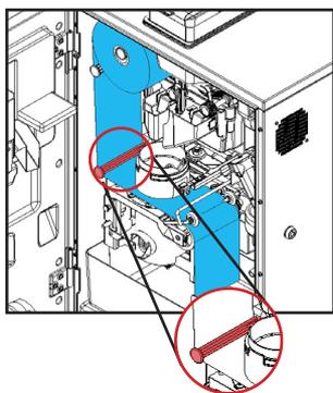
**3** Installer le nouveau rouleau de papier-filtre. Passer le papier sous le support de gauche du système d'infusion, sous la chambre d'infusion, puis sous les roues de guidage, en les soulevant légèrement avec l'étrier.
