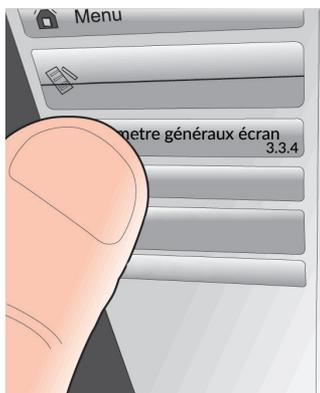
Sous le menu 3 Paramètres machine, sélectionner le menu 3.3 Paramètres écran puis le menu 3.3.4 Paramètres généraux écran.
