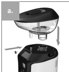
Colocar y fijar la tolva
