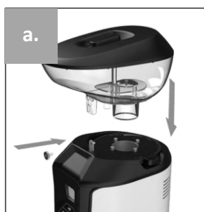
Inserire e fissare la tramoggia
