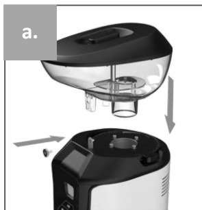
Trichter anbringen und befestigen
