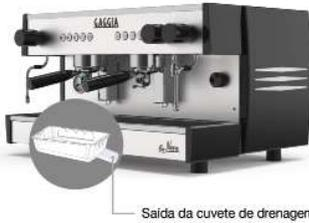
Retirar a bandeja de drenagem e ligar o tubo ondulado fornecido com a máquina à saída da cubete de drenagem (ver figura). Por fim, inserir a outra extremidade na drenagem geral do estabelecimento.
