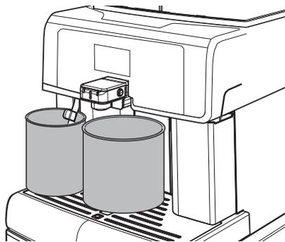
La machine démarre la distribution de la solution détartrante par intervalles (la barre indique la progression du cycle).
