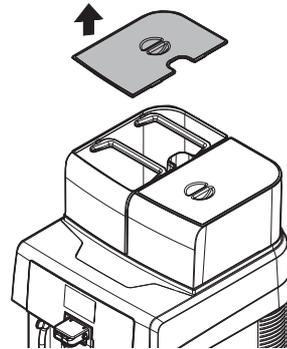
Retirer le réservoir ; le soulever par les poignées prévues à cet effet et installées à l'intérieur.
