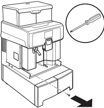
Retirer le couvercle placé sur le côté gauche en dévissant les 2 vis.
