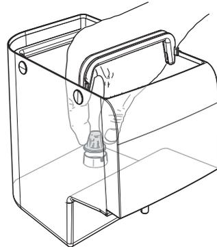
Introduire le filtre dans le réservoir vide. Appuyer jusqu'au point d'arrêt.
