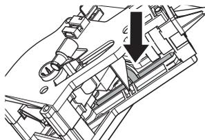
Appliquer la graisse uniformément sur les deux convoyeurs latéraux.
