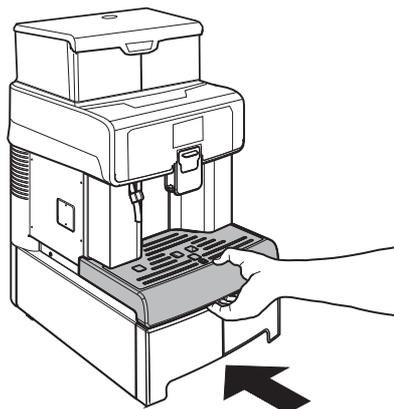
Enlever la couverture avant, en appuyant sur le côté pour décrocher les arrêts de fixation.
