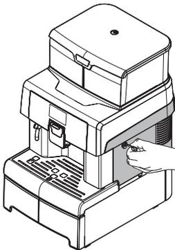
Insérer la tablette de nettoyage dans le groupe de distribution du café et repositionner ce dernier dans la machine, en veillant à réinsérer tous les composants et à fermer le volet.
