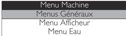
Appuyer sur la touche « DOWN » et sélectionner l'option « DÉTARTRAGE » ;
