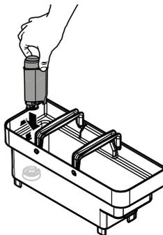
Remplir le réservoir avec de l'eau fraîche potable et le réintroduire dans la machine. Sélectionner « OK » et appuyer sur « OK ». La page-écran suivante s'affiche :
