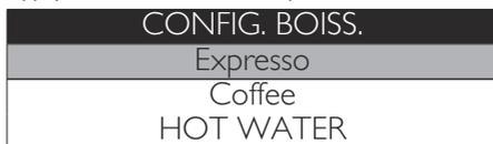
Sélectionner la boisson que l'on souhaite programmer et arrêter la distribution comme indiqué sur l'afficheur lorsqu'on le souhaite. À titre d'exemple, voici la programmation d'un café expresso.
