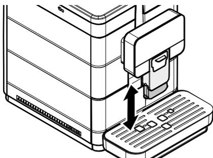
Pour effectuer ce réglage, lever ou baisser la buse de distribution manuellement.
