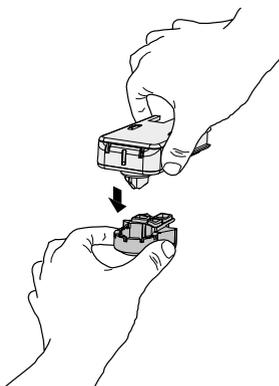
Tourner le couvercle du Cappuccinatore et le soulever pour le démonter du corps du Cappuccinatore.
