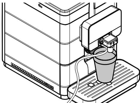
Sélectionner « OK » et appuyer sur « OK ». La machine distribue une quantité d'eau suffisante pour rincer le circuit du lait. Les écrans suivants s'affichent :
