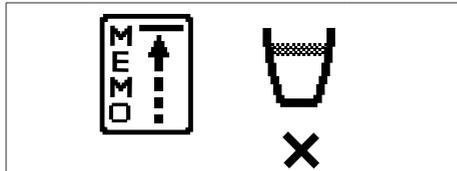
Le « X » sous la tasse indique qu'il est poss. de bloquer le processus (on est encore en phase de mouture) Si l'on presse alors la touche « OK », l'enregistrement est annulé. On ne peut sauv. le régl. de la dose que lorsque le « V » appar. sous la tasse sur l'affich.
