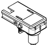
**Raccord de droite pour Cappuccinatore** : permet de relier le Cappuccinatore au réservoir à lait positionné sur le côté droit de la machine.
