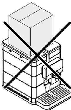
**⚠** Étant donné le poids total, il est interdit de superposer plus de trois machines. La machine doit être stockée dans son emballage d'origine dans des lieux NON humides et/ou poussiéreux.
