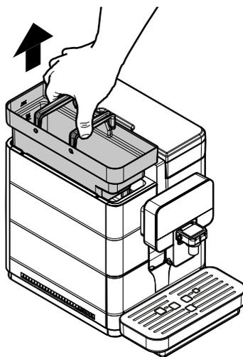
Rincer le réservoir et le remplir d'eau fraîche ; ne pas dépasser le niveau (MAX) indiqué sur le réservoir.
