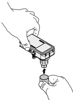
Insérer le tuyau sur le côté gauche du raccord.
