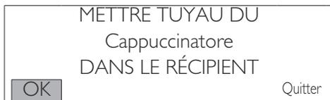
Insérer le tuyau propre directement dans le récipient. Appuyer sur la touche « OK » pour confirmer.
