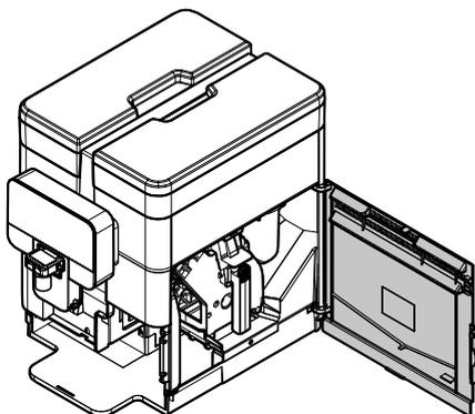
Refermer le volet et distribuer 1-2 cafés pour vérifier la variation du degré de mouture. Répéter l'opération jusqu'à obtenir le degré de mouture désiré. Les repères indiquent le degré de mouture réglé ; il est possible de régler des degrés différents de mouture avec les références suivantes :
