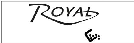
Si le tiroir à marc n'a pas été vidé, après 5 cycles de distrib. de café la machine se bloque et l'afficheur montre :
