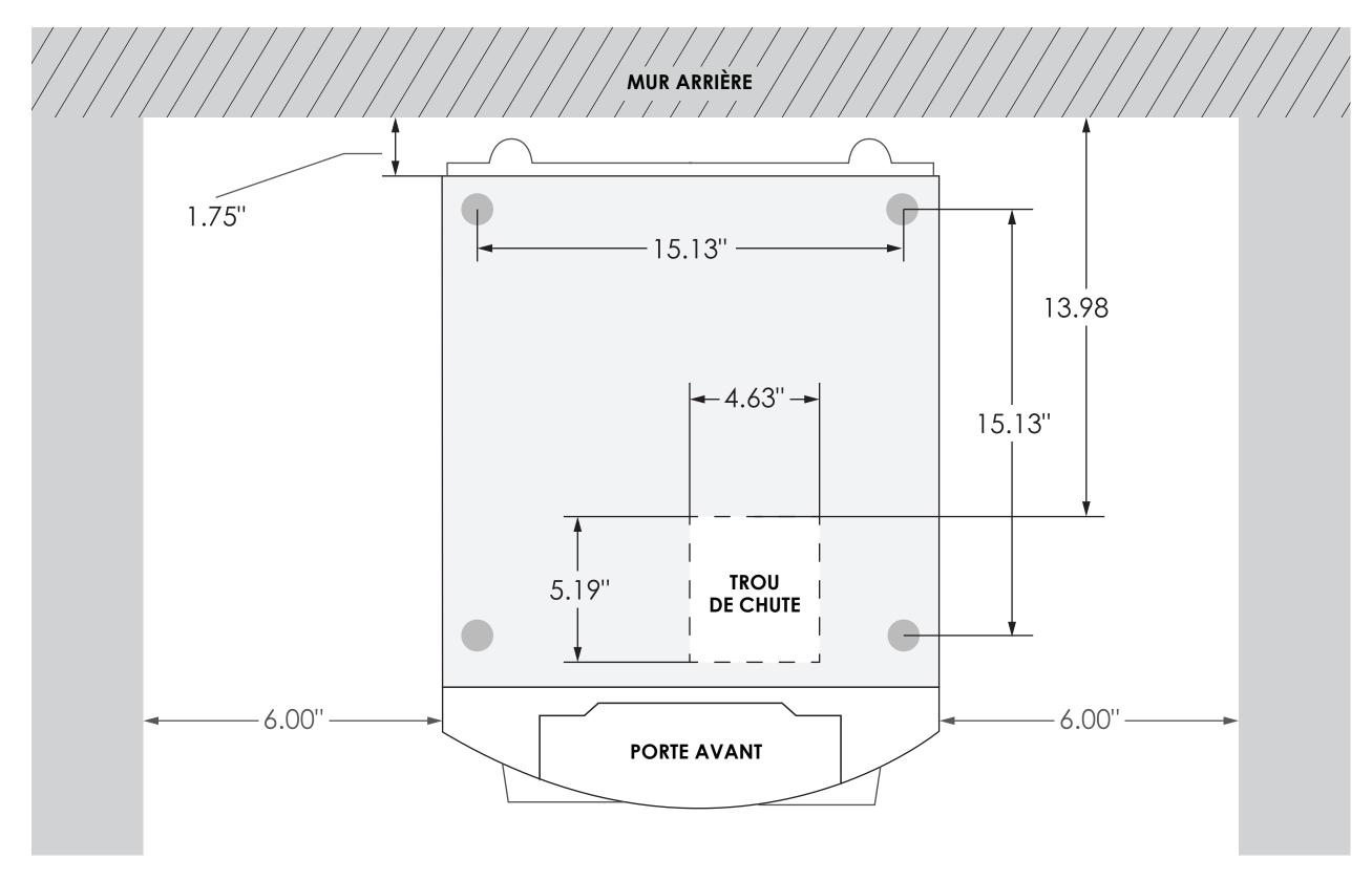
«LES ARÊTES DU TROU DE CHUTE DEVRAIENT ÊTRE SCELLÉES AVEC DU SILICONE OU UN AUTRE SCELLANT APPROPRIÉ POUR PROTÉGER LE COMPTOIR DES DOMMAGES PAR L'EAU.»
