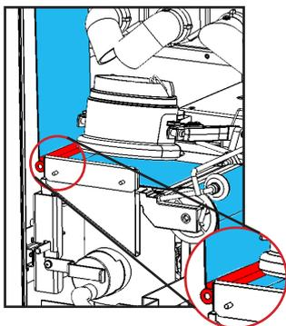
**3** Installer le rouleau de papier-filtre. Passer le papier sous le support de gauche du système d'infusion, sous la chambre d'infusion et sous les roues de guidage en les soulevant légèrement avec l'étrier. Réinstaller le panneau de protection et refermer la porte.
