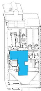
**2** Ouvrir la porte de la machine, retirer le panneau de protection puis retirer le rouleau de papier vide.
