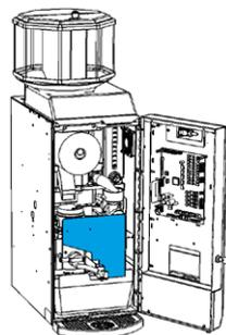
**3** Installer le rouleau de papier-filtre. Passer le papier sous le support de gauche du système d'infusion, sous la chambre d'infusion et sous les roues de guidage en les soulevant légèrement avec l'étrier. Réinstaller le panneau de protection et refermer la porte.
